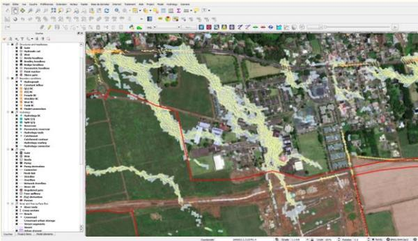
hydra vous offre la possibilité de coupler la modélisation d'écoulements de surface (ruissellements ruraux et urbains, débordement de cours d'eau) avec la modélisation d'écoulement en réseaux unitaires ou pluviaux.
